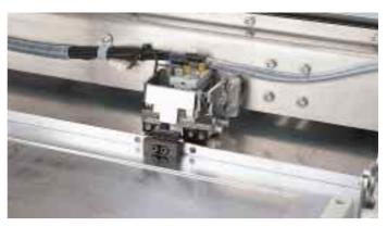
Auto-eject cassette mechanism Automatischer Kassettenauswurf Dispositif d'éjection automatique de cassette Mecanismo de explusión automática de casete
